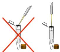
打开瓶盖, 用移液管缓慢(5秒)将样品移到准备好的色谱柱树脂层中心。关紧螺帽并再次松开半圈。
